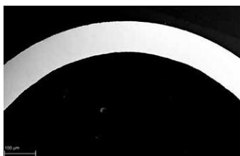
Reibungsarme Führung durch hochwertige Polierung der CORAZOR Stanzbiopsie-Kanülen – selbst bei gebogener Kanülenführung.
